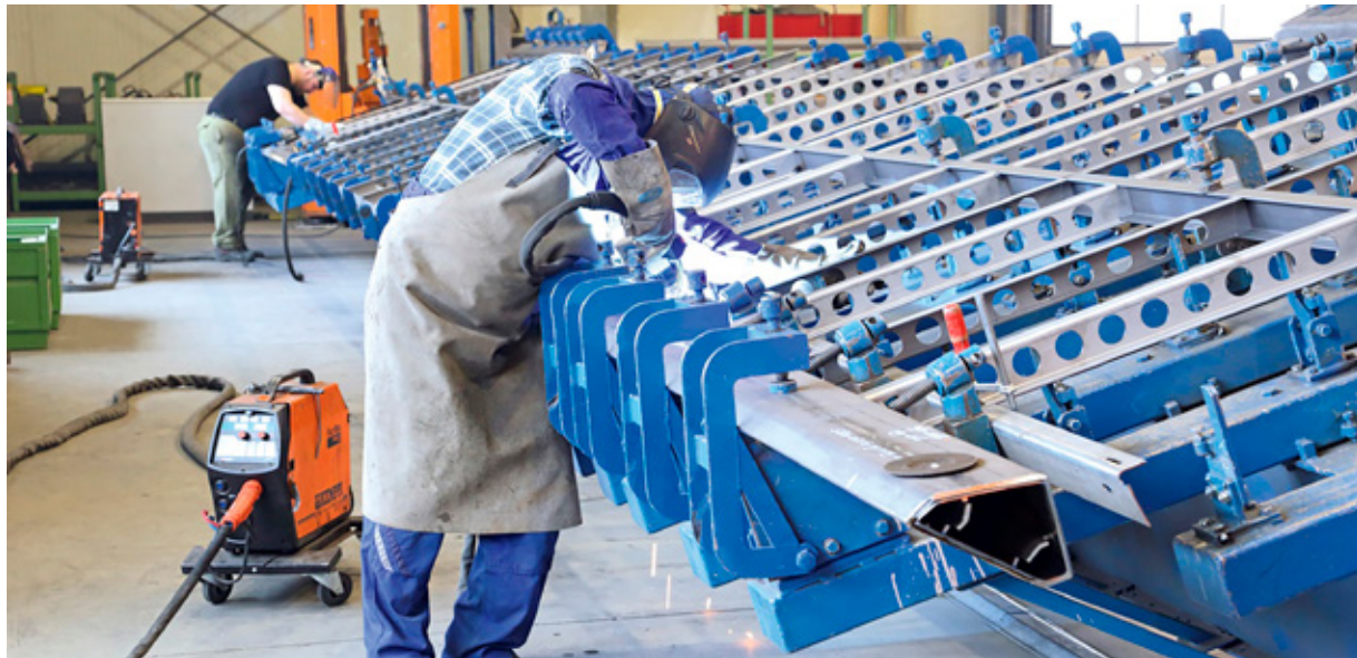
Schweißarbeiten an Baugruppen für den Schienenfahrzeugbau
